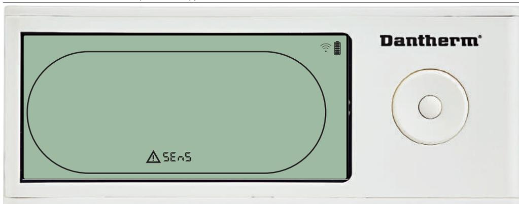
При обнаружении неисправности датчика осушитель прекращает работу.
