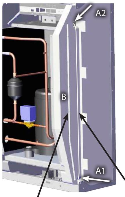
Внешний датчик относительной влажности/ температуры воздуха
