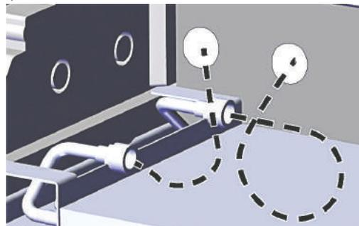
5. Закрепить нагревательный элемент в передней части двумя винтами слева и справа.
