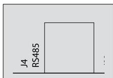
Интерфейс RS-485 задействует протокол Modbus RTU как подчиненное устройство. Адрес устройства отсутствует.
