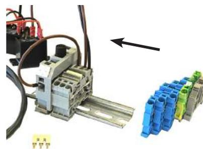
3. Также блок клеммной рейки можно установить, защелкнув его на рейке.
