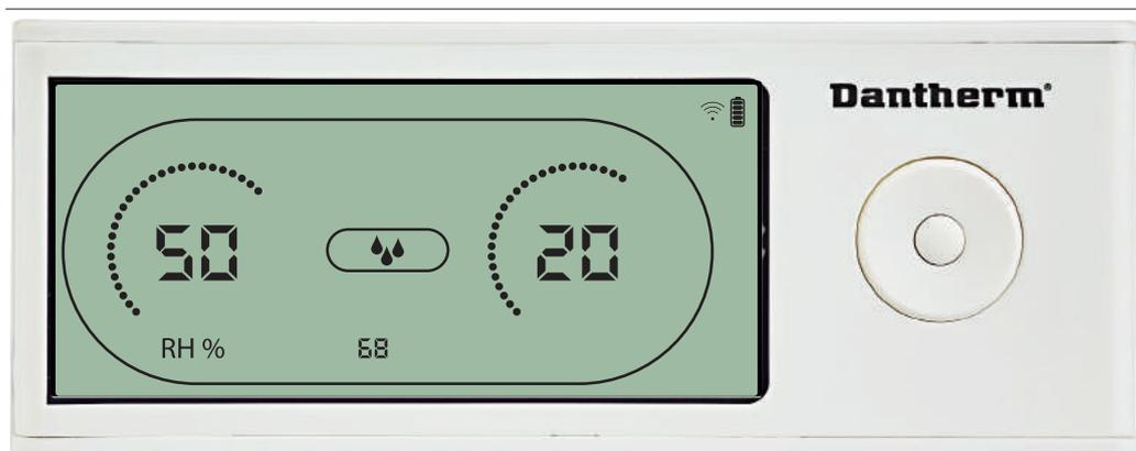
Значение влажности и символ осушения мигают. На дисплее отображается желаемое значение влажности. Пока значение мигает, его можно увеличить или уменьшить нажатием кнопок панели управления DRC1 Вверх (увеличить) или Вниз (уменьшить). Для подтверждения выбранного значения влажности и перехода к следующей странице меню необходимо нажать Ввод.
