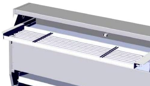
3. Снять резиновую заглушку и ввести кабель в компрессорный отсек.
