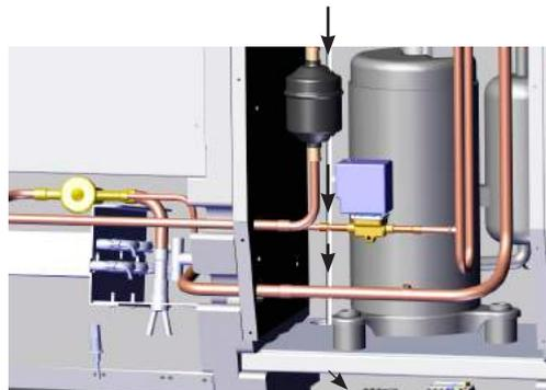
7. Открыть доступ к клеммной рейке, сняв резиновую заглушку.
