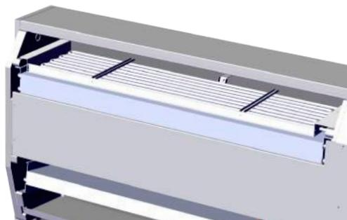
5. Закрепить нагревательный элемент двумя винтами слева и справа.
