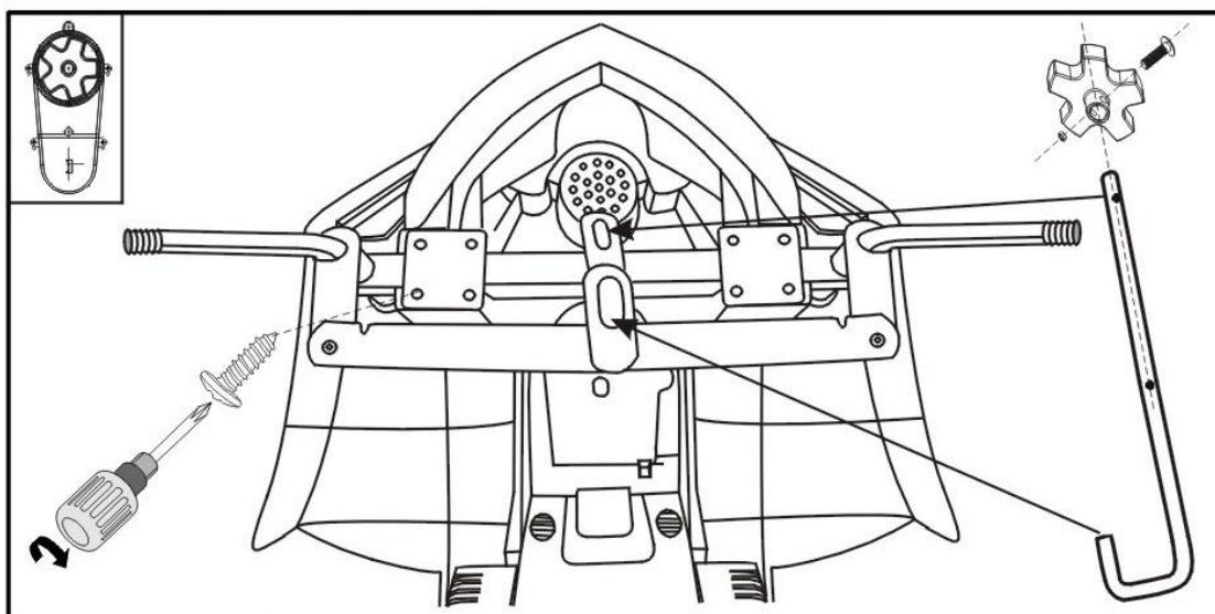
Поставьте ось направления прямой стороной в кузов автомобиля снизу, зафиксируйте неподвижный блок ДУ в коробке передач так, чтобы ось направления оказалось в отверстии в приборной панели. Изогнутую сторону оси поместите в железную часть руля.
