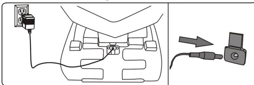
1. Откройте защитную крышку батарейного отсека(разъем зарядки находится под крышкой топливного бака).
