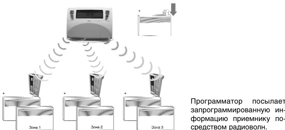
Программатор посылает запрограммированную информацию приемнику посредством радиоволн.
