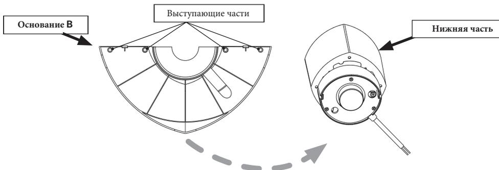
2. При сборке корпуса нагревателя, вставьте четыре выступающих части основания В в соответствующие отверстия основания А. В основании В два разъёма. Основание В должно быть вставлено в основание А, до характерного щелчка.
