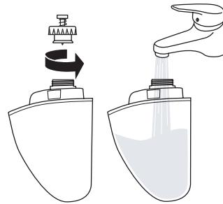
Не транспортируйте прибор с наполненным резервуаром для воды. При транспортировке поверхность воды будет раскачиваться, и вода может подняться поверх распылительной мембранны. Это может нарушить работу распылителя.
