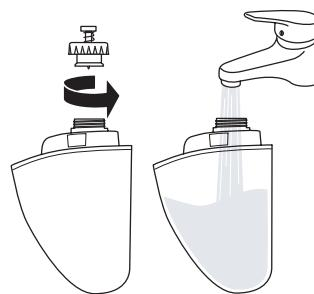
Csavarja rá ismét szorosan a tartály fedelét, és törölje le az esetleges vízcseppeket a tartályról. Ügyeljen a fedél tömítés helyes állására. Helyezze a víztartályt ① lefelé néző töltőnyílással a készülékre.
