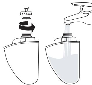
Ponownie przykryć korek zbiornika i ewentualnie wytrzeć pozostałe na zbiorniku krople wody. Zwrócić uwagę na prawidłowe położenie uszczelki pokrywy. Nałożyć na urządzenie zbiornik wody ① otworem wlotowym skierowanym w dół.
