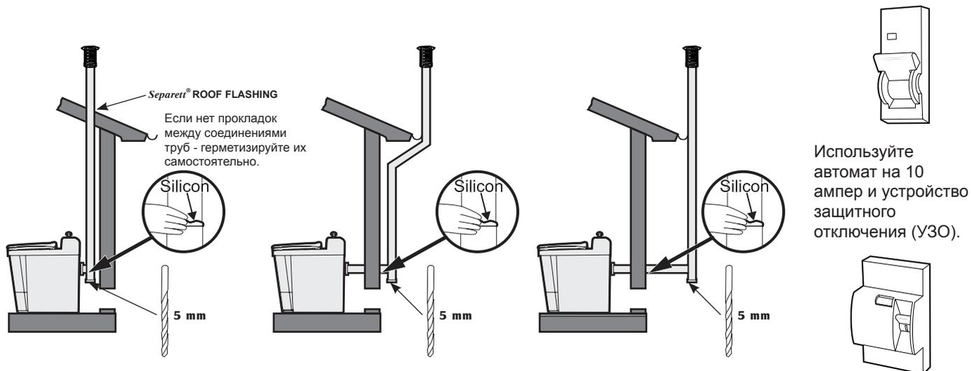
Выводите вентиляционную трубу (вытяжной воздух) из туалета длиной максимум 6 метров и 1 изгибом под 90° и двумя изгибами по 45° Ø110 мм. Горизонтальная труба может иметь максимальную длину 700 мм и Ø110 мм и наклонена наружу для стекания конденсата из туалета.
