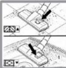
**Насадка для стен и пола** имеет два положения ворса. При убранном ворсе используется для уборки мягких поверхностей: ковры, напольные покрытия. При выдвинутом ворсе используется для уборки гладких поверхностей: пол, стены, потолок.
