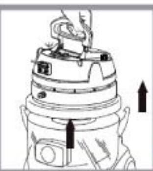
**Внимание!** Пылесос имеет автоматическое защитное устройство, отключающее двигатель, если блок двигателя по ошибке будет снят с резервуара для воды во время работы прибора. В этом случае прибор остановится автоматически и на блоке двигателя загорится красный индикатор.
