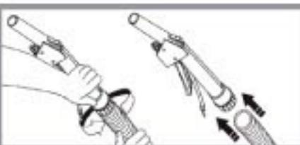
Наверните (против часовой стрелки) на конец шланга для влажной уборки рукоятку устройством для регулировки подачи моющего раствора.
