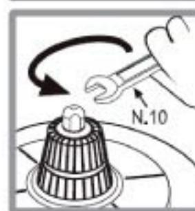
Открутите фиксирующую гайку ключом № 10
