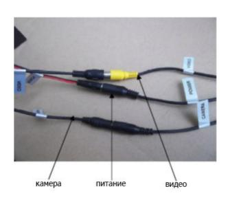
В первую очередь подключите аккумулятор к кабелю питания экрана, затем подключите кабель вывода питания и входные AV-разъемы.
