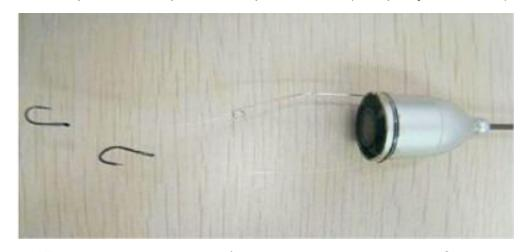
Примечание: НЕ крепите леску с рыболовным крючком непосредственно на кабель камеры. Это может повредить кабель. Крепите леску в специальную канавку на нижней части корпуса камеры.
